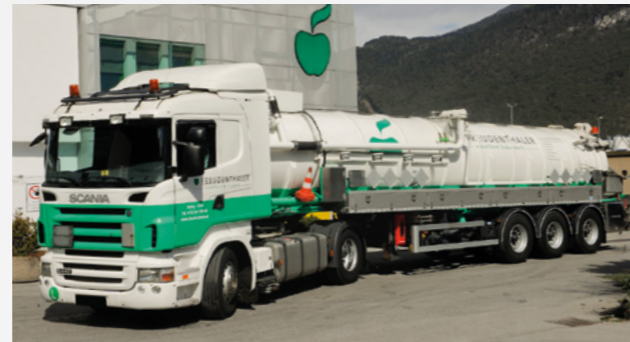
Saugtankwagen mit 20 Tonnen Fassungsvermögen
